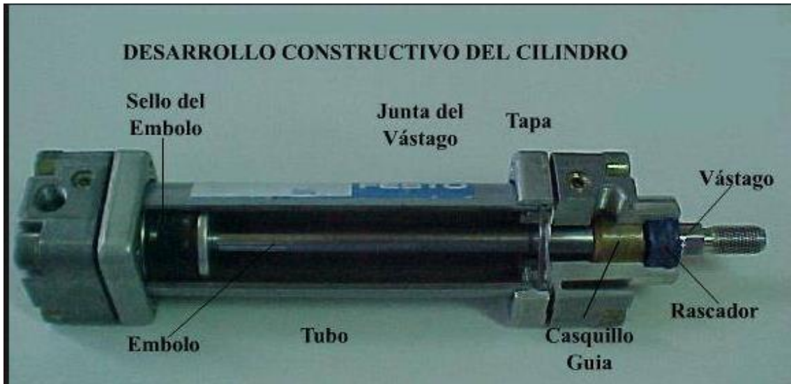
Figura 6. Cilindro Neumático con sus partes más importantes que lo componen.
