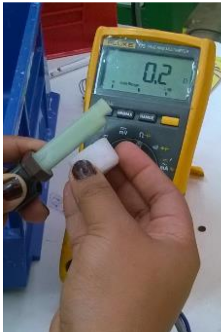
Figura 21. Lectura de resistencia con imán.
