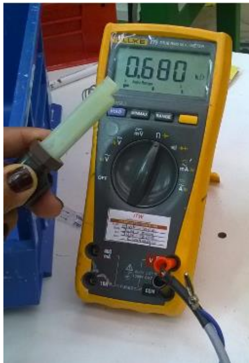
Figura 19. Lectura de resistencia sin imán.
